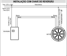
Importante: O cabo de aterramento (verde) do motor deverá ser ligado ao condutor de aterramento da instalação elétrica, conforme a norma NBR 5410.
